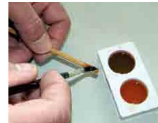
A legno asciutto inizio ad unire i vari pezzi. Posso farlo in modi diversi: unirli con un punto di colla a caldo e lasciare così; un punto di colla e mascheratura con le legature; eseguire solidamente le legature e spalmarle con la colla vinilica che una volta asciutta unirà saldamente filo e legno; unione con sola legatura, ben fatta e robusta.
