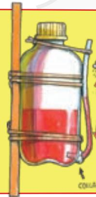
Il barometro di Goethe è uno strumento molto antico che consente di misurare le variazioni della pressione atmosferica. Se la pressione **cre**sce, avremo **bel tempo** e la colonnina dell'acqua **scenderà** nel tubo indicatore. Se la pressione **scende** avremo **cattivo tempo** e la colonnina **salirà** nel tubo.
